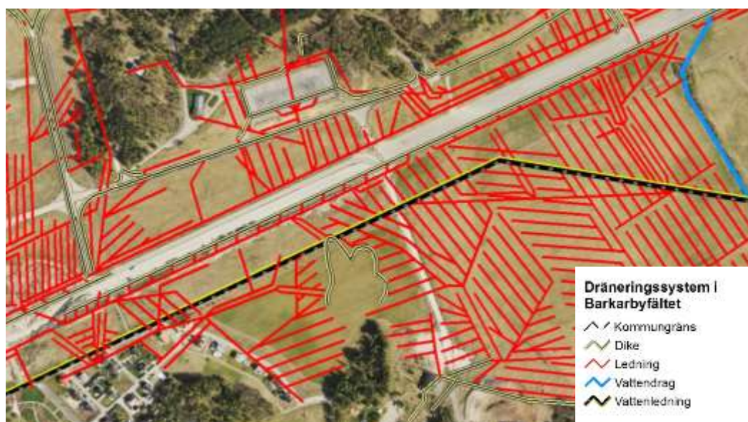
Figur 4. Delar av befintligt avvattningsystem inom det f.d. flygfältsområdet (Fort F).
